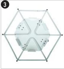
**3** Legen Sie die unteren Rahmenteile auf den montierten Trolley. Richten Sie die Löcher des unteren Rahmens an den Löchern jeder Ecke des Trolleys aus.
