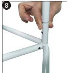
**8** Stellen Sie sicher, dass der Sicherungsstift für jede eingeführte Stange eingerastet ist. Drücken Sie den Stift hinein und drehen Sie die Stange, bis das Loch und der Sicherungsstift ausgerichtet sind. Wiederholen Sie dies für alle 6 Ecken.
