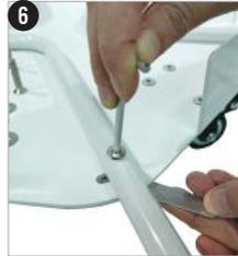
**6** Wiederholen Sie dies für alle 6 Ecken. Verwenden Sie den Schraubenschlüssel und den Inbusschlüssel, um jede Schraube fest anzuziehen.
