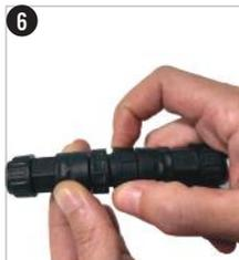
**6** Drücken Sie die beiden Enden des Kabels ineinander und schrauben Sie dann den mittleren Sicherungsring fest, um die Verbindung zu sichern. Verdrehen Sie die beiden Verbindungen nicht, sondern drehen Sie nur über den Ring.
