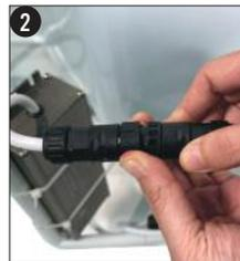
**2** Stecken Sie den zweipoligen Stecker vom LED-Netzteil in den entsprechenden Stecker am weißen Kabelbaum. Sichern Sie den Stecker durch Drehen des Sicherungsringes.
