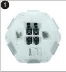
**1** Legen Sie den Trolley mit der Unterseite nach oben auf einen Tisch. Positionieren Sie jedes der Lenkrollen so, dass es mit den 4 vorgebohrten Löchern übereinstimmt. Stellen Sie die feststellbaren Lenkrollen auf die gerade Seite des Trolleys.
