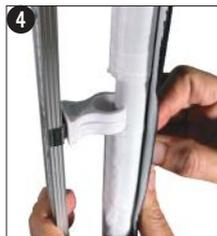
**4** Die LED-Leisten können nun an die vertikalen Stangen befestigt werden, indem die Rohrschelle in den Raum zwischen den Klettbindern gesteckt wird.
