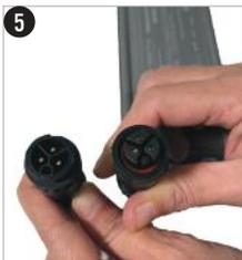
**5** Suchen Sie das Eingangskabel für den LED-Treiber. Es sollte mit dem 3-Pin Stecker des LED-Treibers verbunden werden. Stellen Sie sicher, dass sie übereinstimmen.
