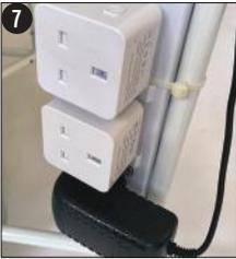
7 Stecken Sie die beiden WiFi-Smart-Steckdosen-timer in die beiden anderen Buchsen der Steckdosenleiste. Jeder dieser Timer regelt den Pumpen- und Lichtplan.
