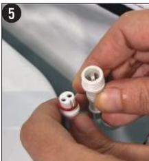
**5** Wiederholen Sie den Vorgang für alle 6 LED-Lichtleisten. Schließen Sie anschließend den weißen Kabelbaum an den entsprechenden Anschluss an der LED-Lichtleiste an.
