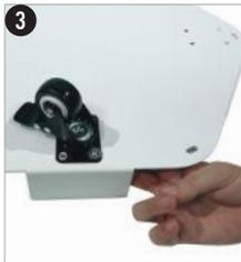
**3** Halten Sie die Schraube mit dem Finger an der Unterseite der Trolleyplatte fest, legen Sie die Unterlegscheibe auf die Schraube und beginnen Sie, die Mutter handfest anzuziehen.
