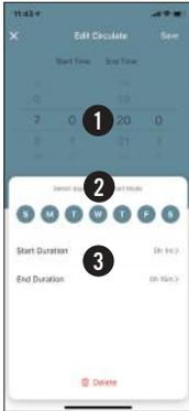
Wir empfehlen, die Pumpe alle 10-20 Minuten für 1 Minute laufen zu lassen, aber Sie sollten diese Einstellung je nach Klima und Temperatur anpassen.
