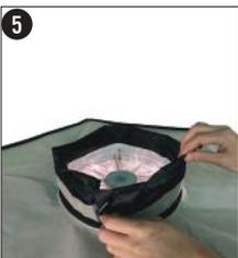
**5** Stellen Sie sicher, dass der Lüfter durch den Schornstein springt. Ziehen Sie das Schornsteingewebe hoch und wickeln Sie es um den Ventilator.
