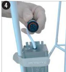
**4** Stellen Sie sicher, dass der 2-Pin Stecker nach oben gerichtet ist und wie abgebildet nach oben führt.
