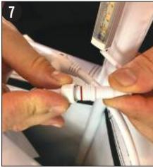
**7** Sichern Sie den Sicherungsring, indem Sie ihn nach unten über die beiden Anschlüsse führen.
