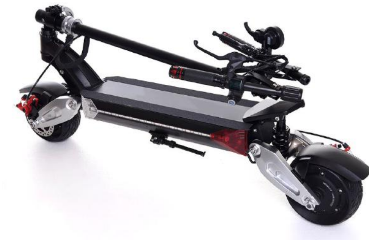
Løbehjulets styr og rat stammen kan foldes for at mindske størrelsen under transport.
