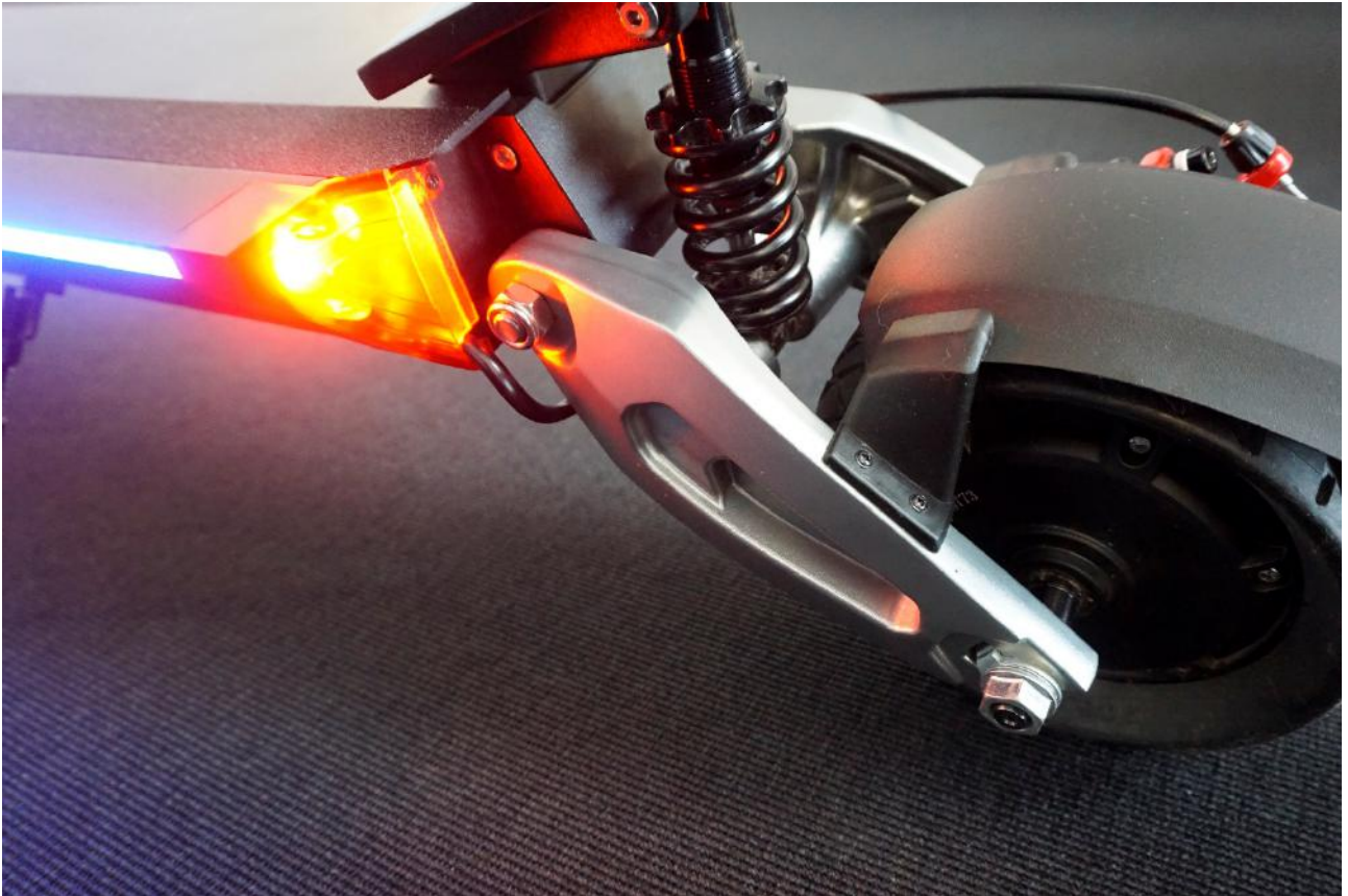
Løbehjulet er udstyret med bremselys der aktiveres når man bruger bremsene.
