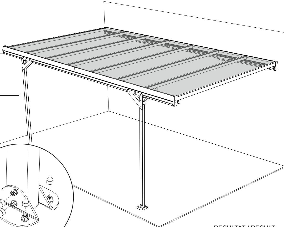
FR : Mettre les caches écrous sur l'ensemble des écrous
